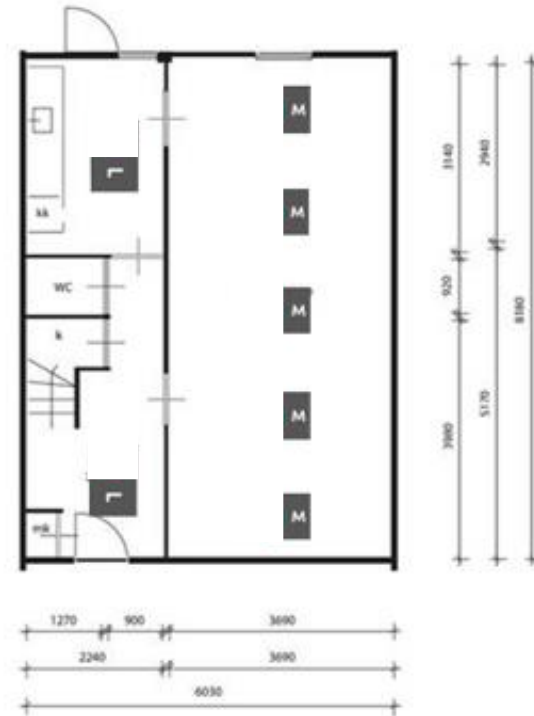
Plattegrond met positionering & type warmtepanelen woning 1
